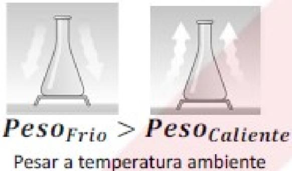
La diferencia de temperatura entre la muestra y el ambiente ocasiona corrientes de aire, las cuales ejercen una fuerza que altera las mediciones.
